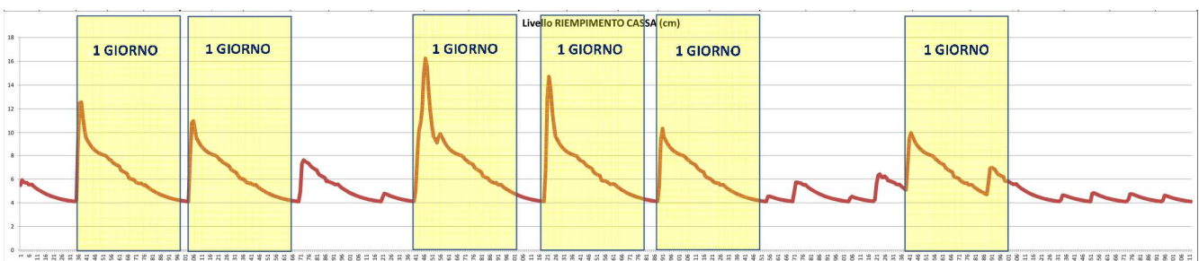
Figura 74 – Durata dei 15 eventi di riempimento e svuotament della cassa indicate nella figura precedente
