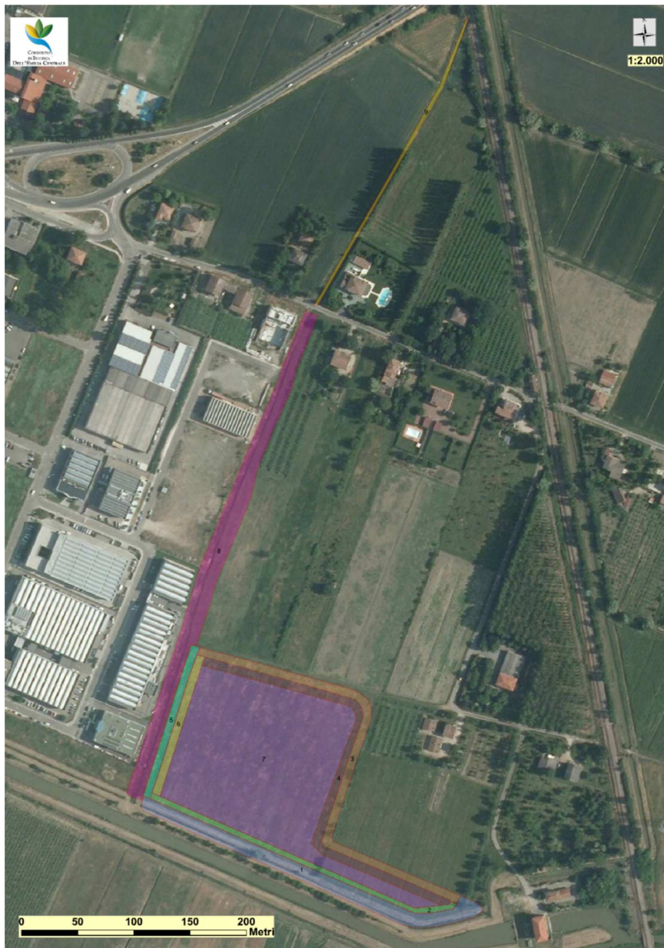
Figura 36 - Aree di lavoro relative alle diverse fasi di cantiere (indicate nella tabella precedente)
