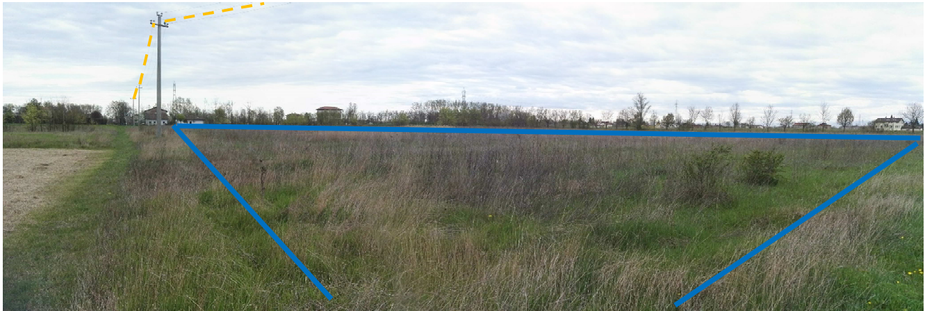
Figura 86 – Nella foto in alto: tracciato della linea elettrica aerea (in arancione) e interrata (in rosso) e indicazione degli argini della cassa (in blu). Nella foto in basso: la medesima linea elettrica aerea in corrispondenza del sito di costruzione dell'argine nord della cassa di espansione; in arancione la linea aerea, in blu il tracciato indicativo dell'argine della cassa, che mostra come non vi sia interferenza.
